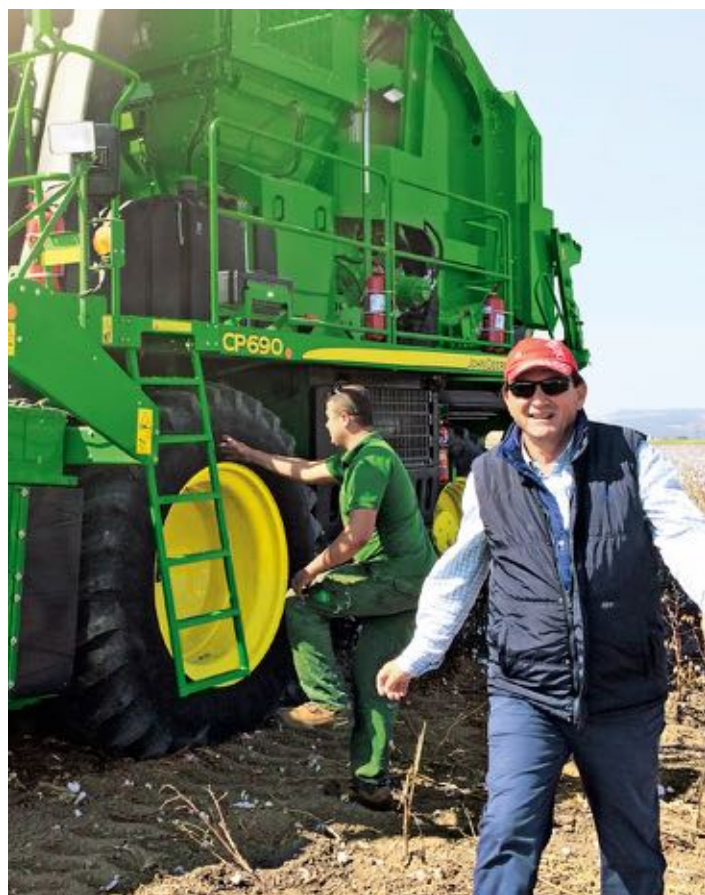
Un homme, une machine : Seref Iyiyarlar et sa John Deere CP690, capable de récolter quatre hectares par heure.
